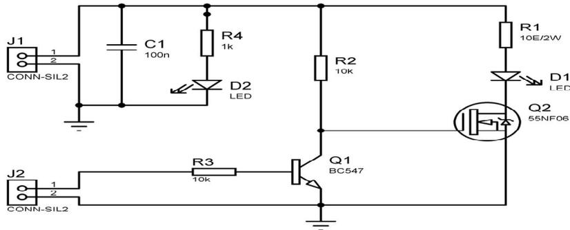
**.Fig 3 Transmitter circuit**
