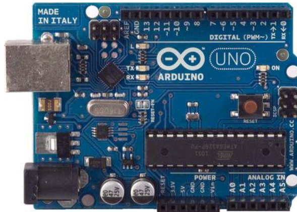
Fig:-1 Arduino Uno Board
