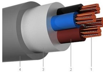
**Figure 1** 3x2,5 mm<sup>2</sup> and 3x1,5 mm<sup>2</sup> 0.3 / 0.5 kV low voltage multi-core cable
